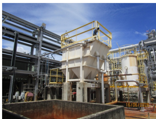
รูปที่ 22 หน่วยแยกน้ำออกจากน้ำมัน (CPI) (2930-TK20) ของ New ETP
